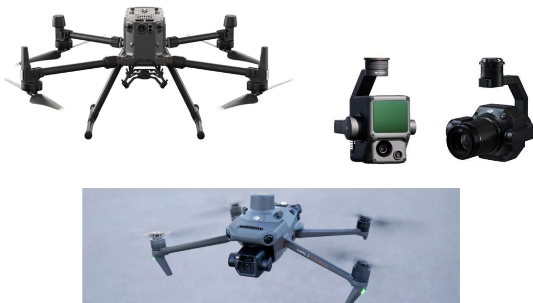
Figura 1 - sistemi APR utilizzati: Dji Matrice 300 RTK e Mavic 3E RTK
