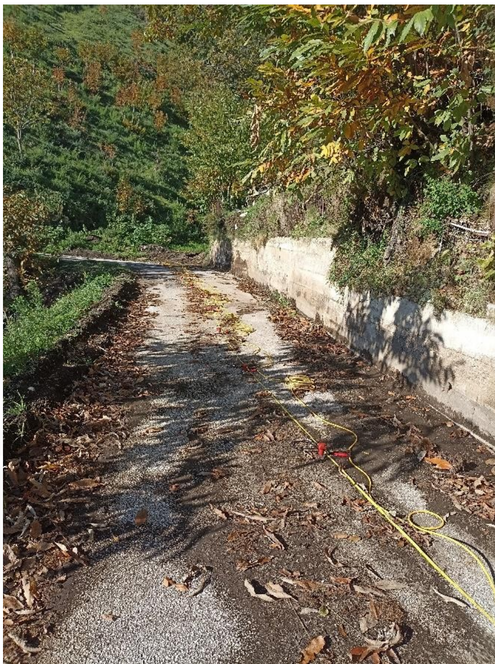
Figura 59 - Stendimento MASW M5
