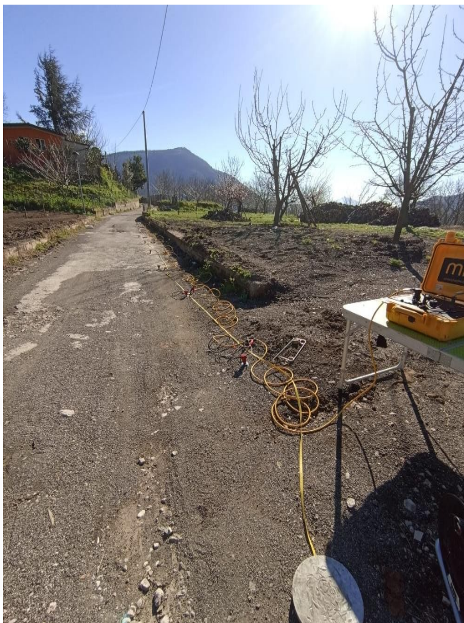
Figura 77 - Stendimento MASW M7
