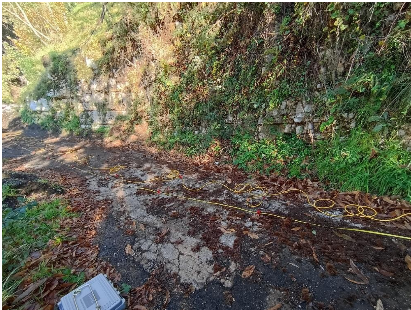
Figura 65 - Stendimento MASW M6
