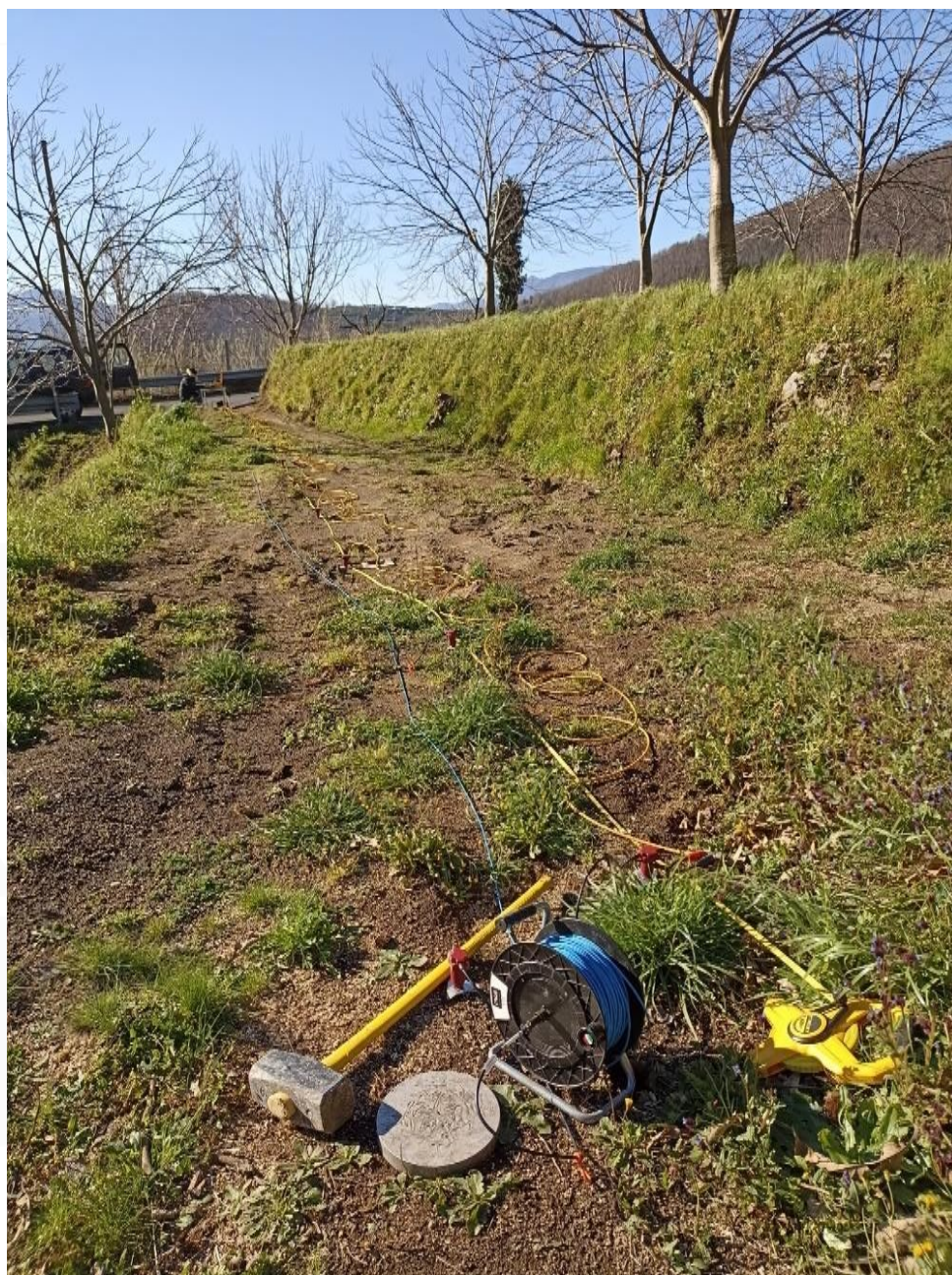
Figura 71 - Stendimento MASW M2
