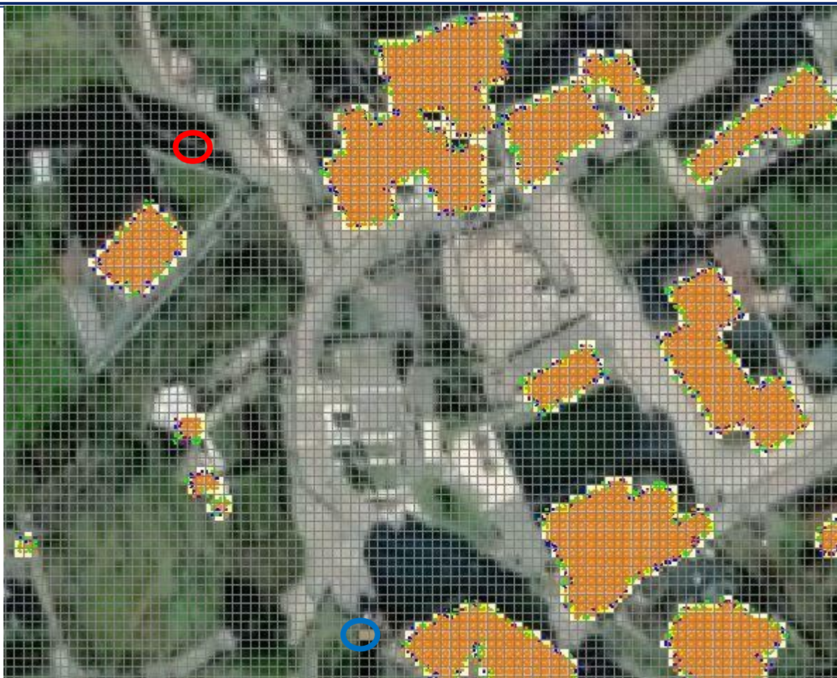
Particolare del dominio di calcolo nella zona del bypass che attraversa il centro abitato in rosso e in blu rispettivamente le celle di ingresso e di uscita del canale
