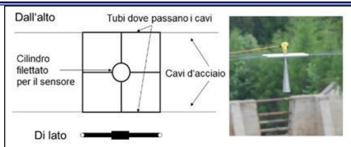
Installazione di un sensore di livello radar su cavi d'acciaio
