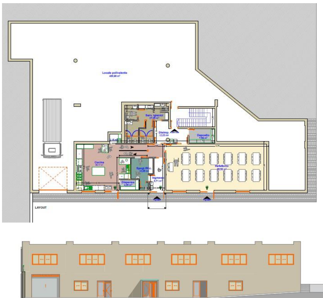
Figura 10: Dimensionamento degli spazi funzionali planimetria e prospetto Sud di progetto
